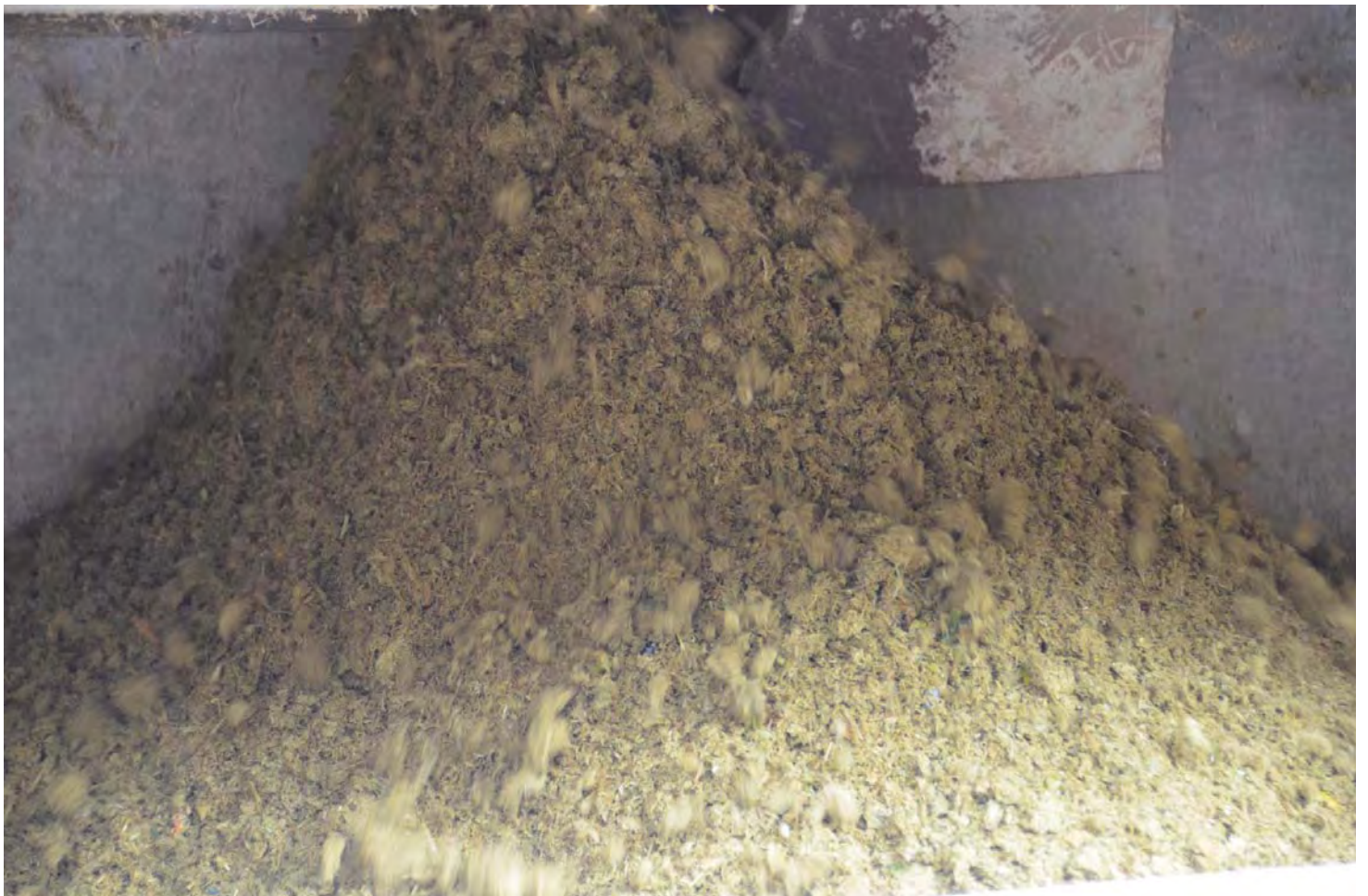
八重瀬町バイオガスプラントの固液分離後の固形物
