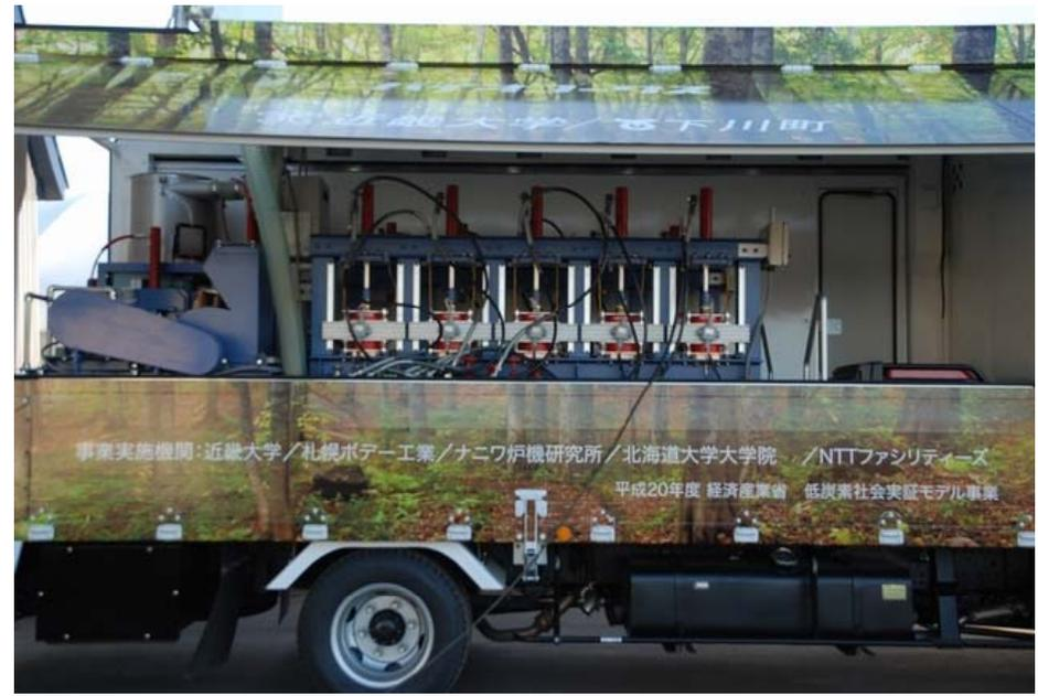
バイオコークス専焼ボイラー装置と加温装置
