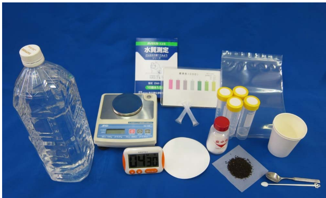
写真2 分析に使う道具(普及センターや生産者向け) ミネラルウォーター、電子天秤、キッチンタイマー、簡易 COD 測定キット、 ろ紙、塩、抽出容器、チャック付きポリ袋、コップ、スプーン、分析する土壌
