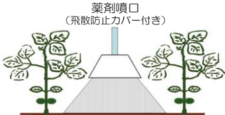
図1 大豆畦間への除草剤処理 (作物に薬剤が付着しないように散布する)
