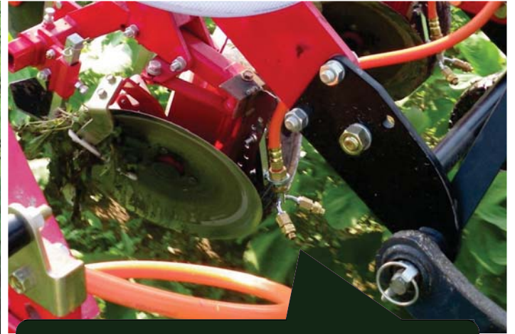
薬剤を中耕培土直前に精度良く雑草に散布して、徹底防除を図る
