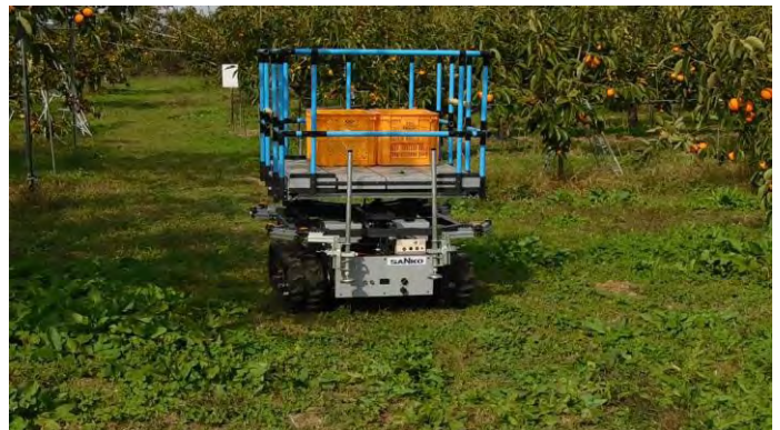
園内の移動はリモコン操作で（速度は、低速～高速間で6段階で変速可能）
