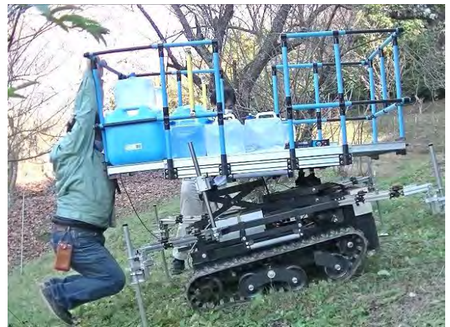
傾斜地で200kg積載しても水平を保ちます
