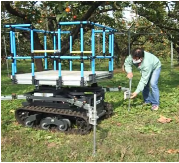
作業するときはアウトリガーで固定し台を前後に広げます
