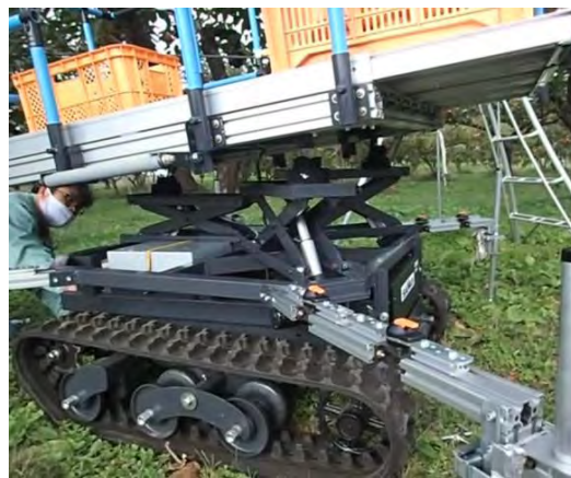
作業台をリフトアップします (特許第6842220号)
