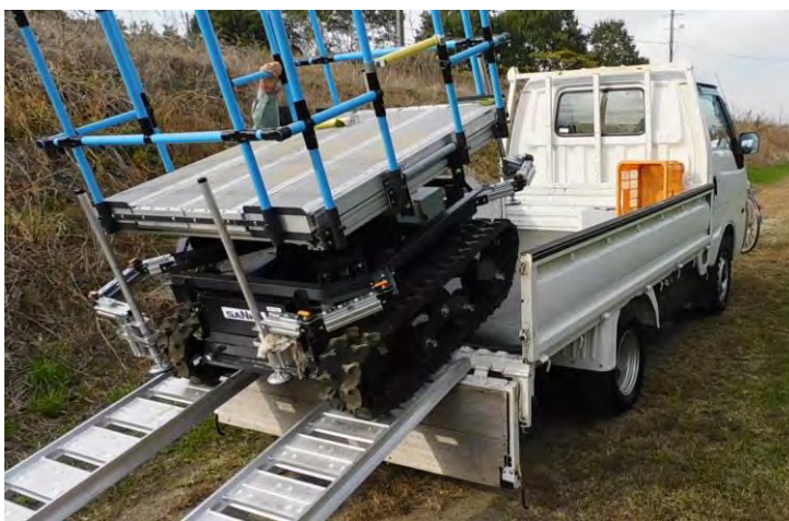
作業現場近くへは1トントラックでらくらく移動
