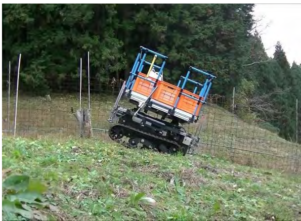
傾斜地を200kg積載したままでも 安定的に走行します
