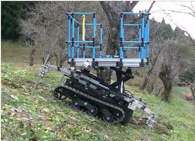
20°の傾斜地で作業台車を水平化させます
