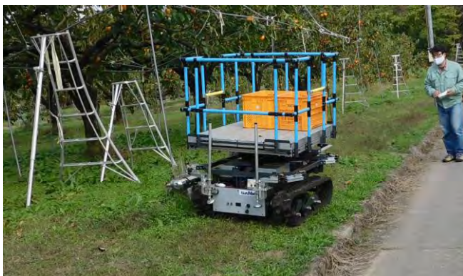
園内の移動はリモコン操作で（速度は、低速～高速間で6段階で変速可能）
