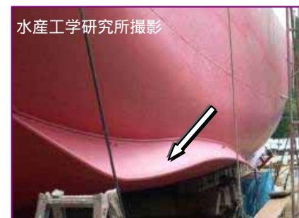
水産工学研究所撮影 流体力学に基づくビルジキール (横揺れ防止装置)の形状変更
