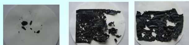
PBSA フィルム PBS フィルム PBSA/PBS 混合フィルム 各種フィルムの分解（処理6日後）
