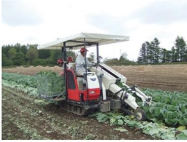
加工・業務用キャベツ収穫機による収穫の様子
