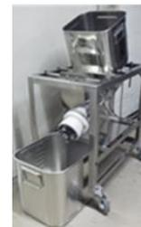
図 1-1 試作した表面加工玄米製造装置
